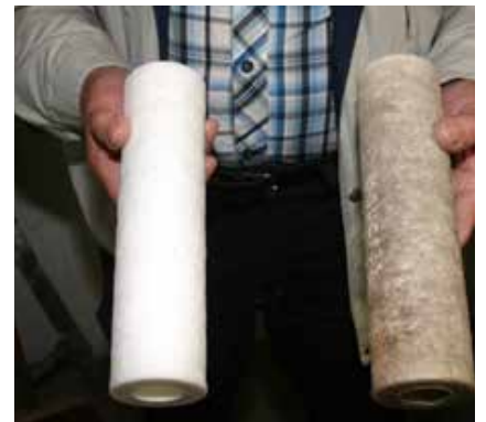
Lämmitysjärjestelmän suodattimeen kertyy sakkaa putkistosta. Suodatin vaihdetaan kerran tai kaksi vuodessa, kun järjestelmästä on poistunut suurin osa sakasta.
